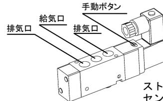
ストップバルブ電磁弁のセンターポートにエアを供給してください。
