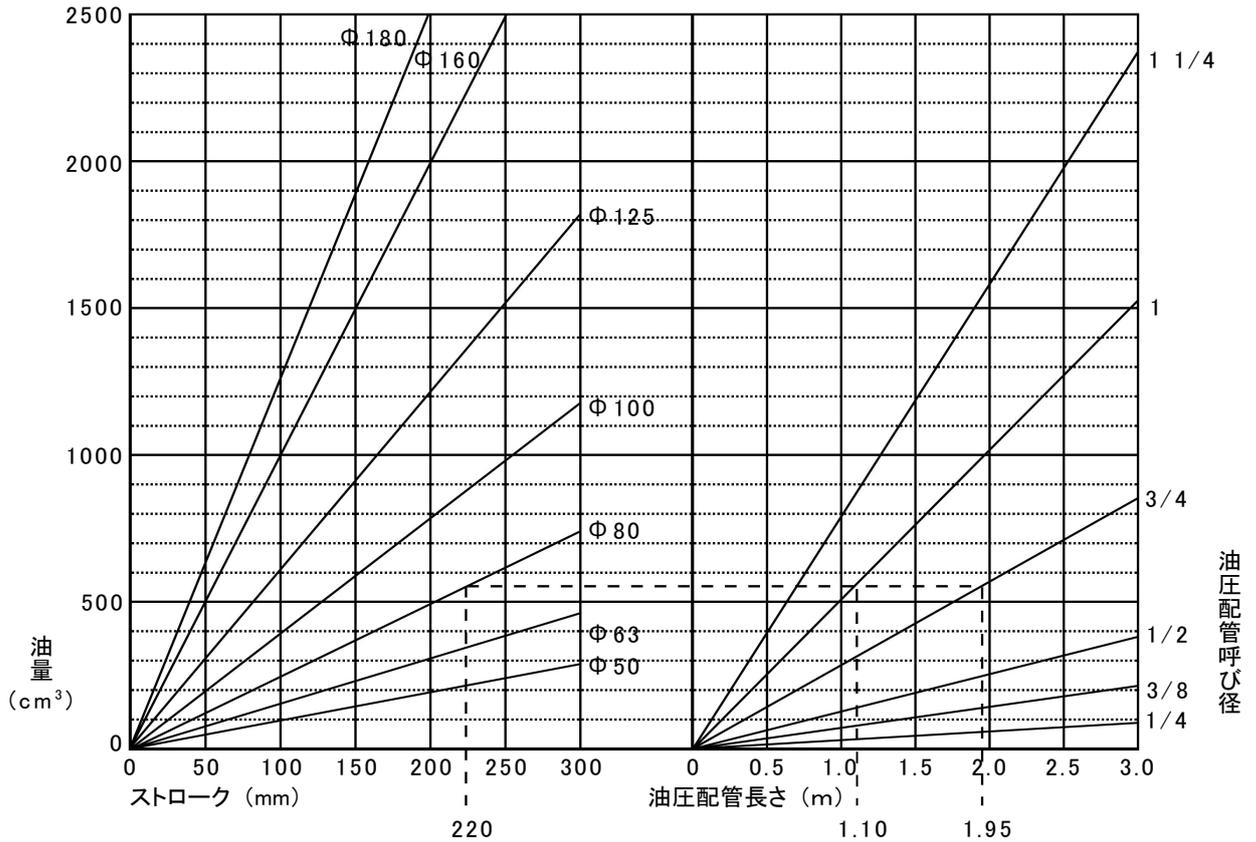
油量は油圧シリンダの内径とストロークから算出した油圧シリンダ内油量の 1/2 の数値 (ヘッド側にオイル供給した場合)
