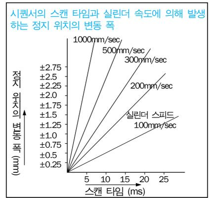
실린더 스피드 300mm/sec 로 스캔 타임 5ms 의 시퀀서를 사용했을 때, 위 그림에 의해 정지 위치의 변동 폭은 1.5mm, 정지 정밀도는 ±0.75mm 로 설정합니다. 또한 밸브의 응답, 실린더 속도, 센서 등의 변동에 의해 정지 정밀도는 위의 값에 가산합니다.
