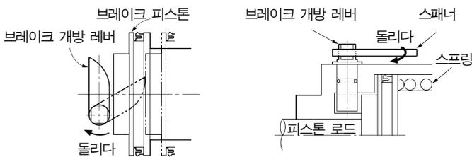
브레이크 개방 레버에 렌치 등을 걸어 시계 방향으로 돌리면 브레이크 피스톤을 밀어 록이 해제됩니다. 또한, 잠금 해제 위치에 있는 브레이크 개방 레버는 원래 위치로 돌아오면 브레이크는 잠기므로 잠금을 해제하는 동안에는 브레이크 개방 레버를 잠금 해제 위치에 유지해 주십시오. 손을 놓으면 브레이크 개방 레버가 원래 위치로 돌아가고 브레이크가 잠깁니다.
