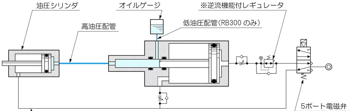
複動式油圧シリンダの場合、ラッシュブースタの戻し側エア配管を分岐して接続するか、常時元圧を供給してください。
