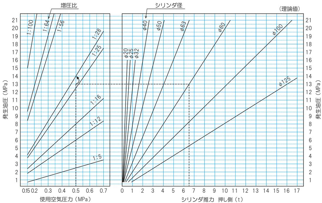
使用空気圧力、必要推力、油圧シリンダ径のそれぞれからラッシュブースタの増圧比、吐出油量を決定します。
