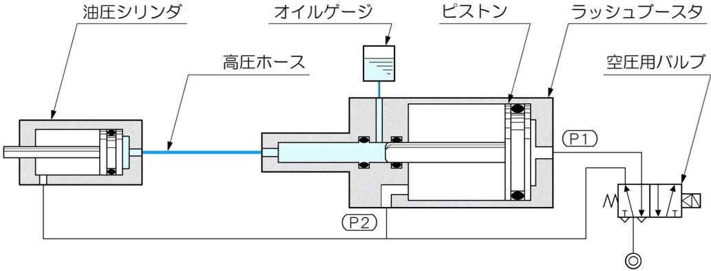
ラッシュブースタの(P1)に給気するとピストンが前進し、パスカルの原理により油が高油圧になり、油圧シリンダは高推力で前進します。戻りは(P2)及び油圧シリンダの戻し側ポートに給気すれば、油圧シリンダはエア圧力により後退します。バネ戻りの単動シリンダの場合は、ラッシュブースタのみエア制御します。
