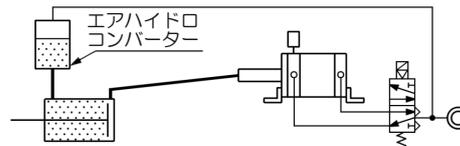
油圧シリンダの戻り側にエアハイドロコンバーターを使用し、戻り側にも油を入れ、エア部分を無くし、気泡の混入を防ぎます。
