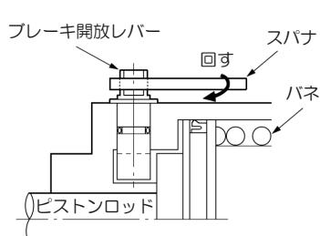
ブレーキ開放レバーにレンチ等を掛けて時計方向に回すとブレーキピストンを押し戻して、ロックが解除されます。尚、ロック解除位置にあるブレーキ開放レバーは元の位置に戻るとブレーキはロックしますので、ロックを解除する間はブレーキ開放レバーをロック解除位置に止めておいてください。手を放すとブレーキ開放レバーは元の位置に戻り、ブレーキはロックします。
