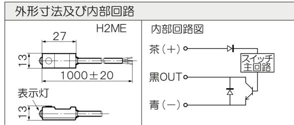
取付けの互換性：有接点スイッチ(RS-6)と無接点スイッチ(H2ME)は同じスイッチ取付け金具でご使用いただけます。
