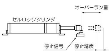
セルロックシリンダの動作中、停止信号が出力されてから実際にブレーキが働き、ピストンロッドが停止するまでに、ブレーキ開放用バルブ、スキャンタイム、エアの給排気等に起因する時間遅れのため、ピストンロッドは必ず、ある量だけオーバーランします。
