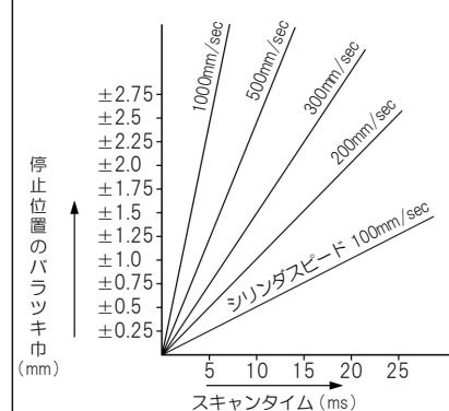
シリンダスピード 300mm/sec でスキャンタイム 5ms のシーケンサを使用した時、上図より停止位置のバラツキ巾は 1.5mm、停止精度は ±0.75mm と設定します。
