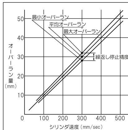
(注) ブレーキ開放用バルブの種類、シーケンサのスキャンタイム、シリンダのスピード変化等により繰り返し停止精度の値は変動します。
