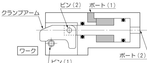
ポート(1)に作動流体を供給すると、クランプアームが後退します。
