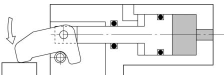
更にポート(2)へ作動流体が流入すると、クランプアームはピン(2)を中心回り、先端は下降し、ワークをクランプします。ポート(1)へ作動流体を供給すれば、②→①と進み、初めの位置に戻ります。
